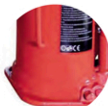
Base de fût soudée (non vissée) pour éviter tout risque de fuites
